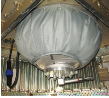
TermoTank thermal covers: for temperature regulation and maintenance الأغطية الحرارية TermoTank: لضبط والحفاظ على درجة الحرارة
